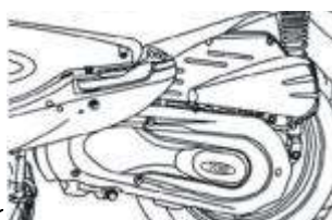
Mangueira de drenagem
